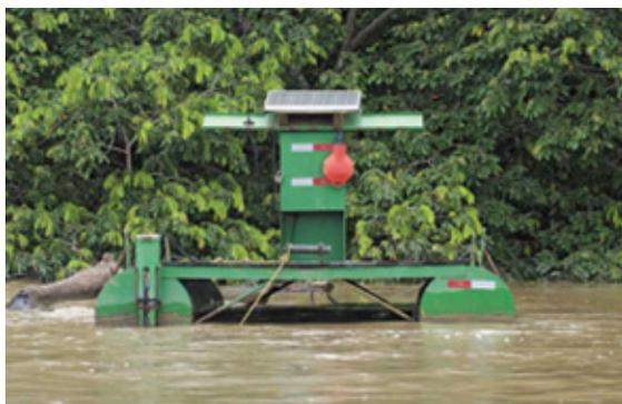
**Figura 19.1: Estação de monitoramento automatizada.**
