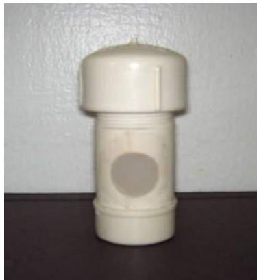
Figura 1: Câmara de ensaio in situ SUNDFELD (2010).
